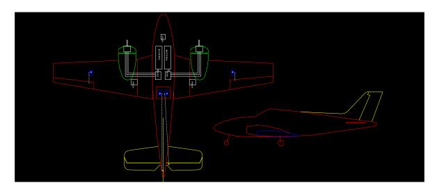
OBS: É preciso fazer cortes em baixo da asa e nas nacele do motor para passagem dos fios. Sugiro que o esc fique dentro da fuselagem.
